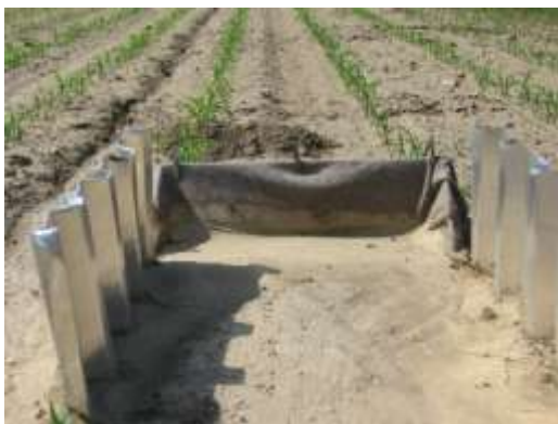
Obr. 1: Erozní kapsa ke sledování smyvu půdy
