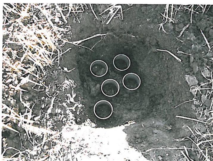
Obr. 6: Odběr vzorků půdy pomocí Kopeckého válečků
