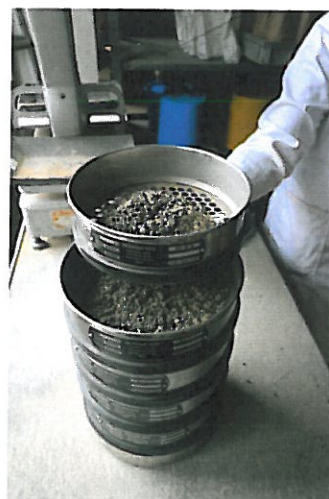
Obr. 8: Prosévání suché zeminy na sítích pro zjištění půdní struktury
