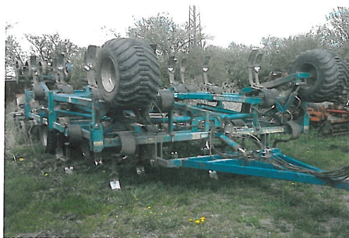
Obr. 5: Univerzální kypřič Köckerling pro zapravení kompostu
