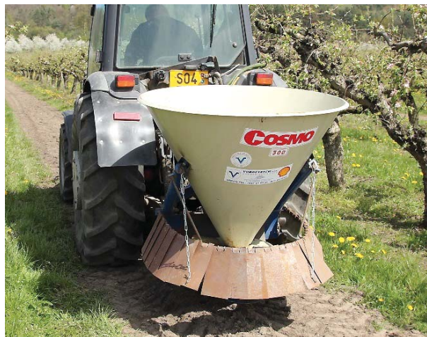
Zábrany usměrňující rozhoz směsi do úzkého pruhu v meziřadí
