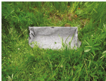
Obr. 2: Instalovaná kapsa pro zachycení erozního smyvu půdy
