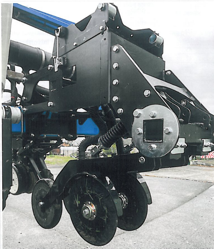
Obr. 2 – Modulární jednotka v provedení tlačném na rámu přesného secího stroje pro kukuřici
