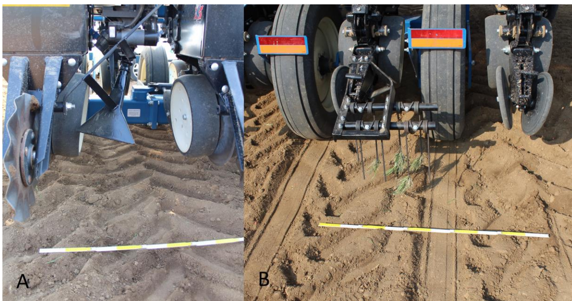
Obr. 3A. Secí jednotka s difuzorem pro výsev komonice, 3B zavlažovače za secí jednotkou (Kintl, 2019).
