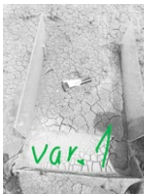
Obr. 9: Zachycený smyv půdy při erozní události během vegetace
