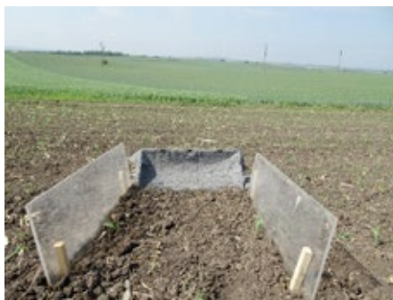
Obr. 8: Erozní kapsa pro záchyt smyvu půdy
