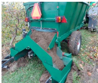
Obr. 5: Vyhrnování kompostu z korby rozmetadla do dvou příkenných řádků
