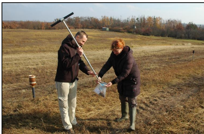
Obr. 15, 16: Odběry půdních vzorků v terénu (vlevo) a zakládání klíčícího pokusu ve skleníku (vpravo).
