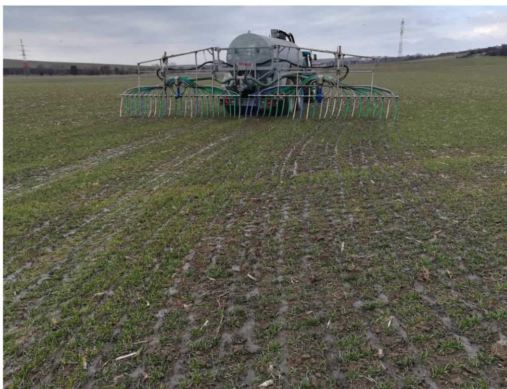
Obr. 4: Aplikace digestátu pomocí hadicového aplikátoru Wienhoff
