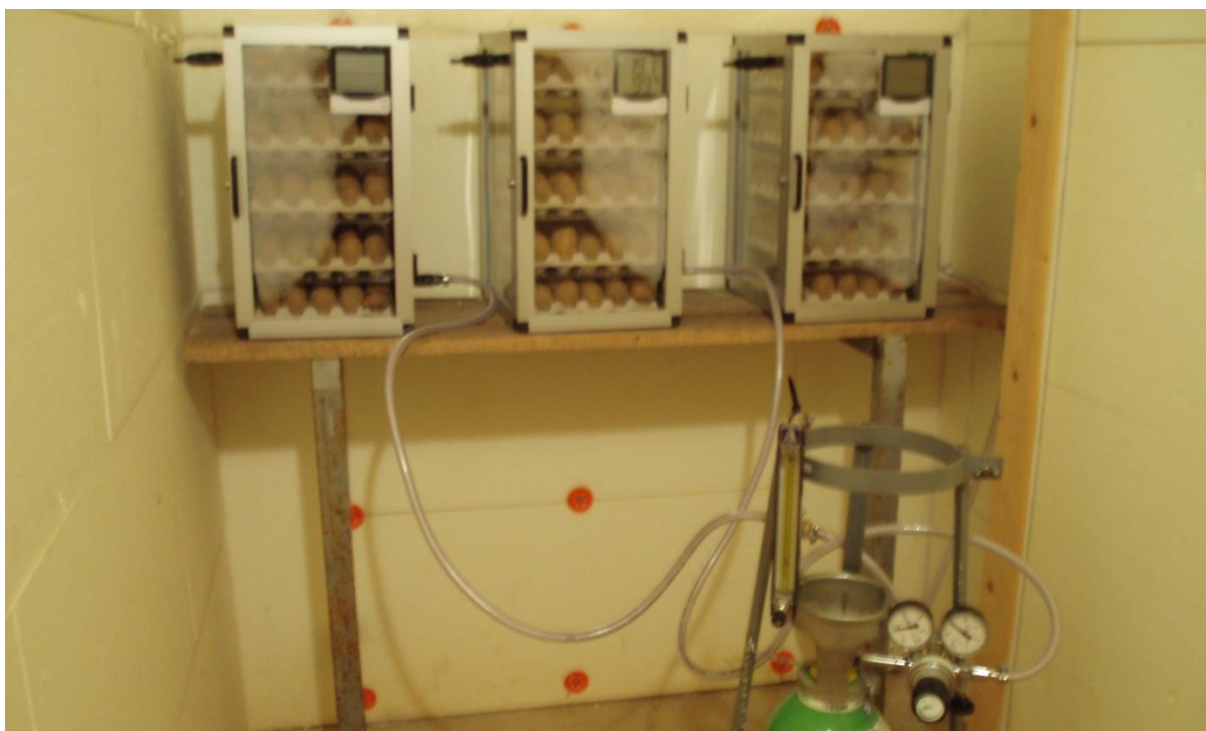
Obr. 1: Ošetření sadbových hlíz etylénem v pokusném skladovacím boxu s teplotou 8-10 °C
