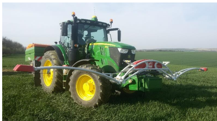
Obr. 15: Mapování porostu a aplikace dusíkatých hnojiv pomocí systému Fritzemier ISARIA
